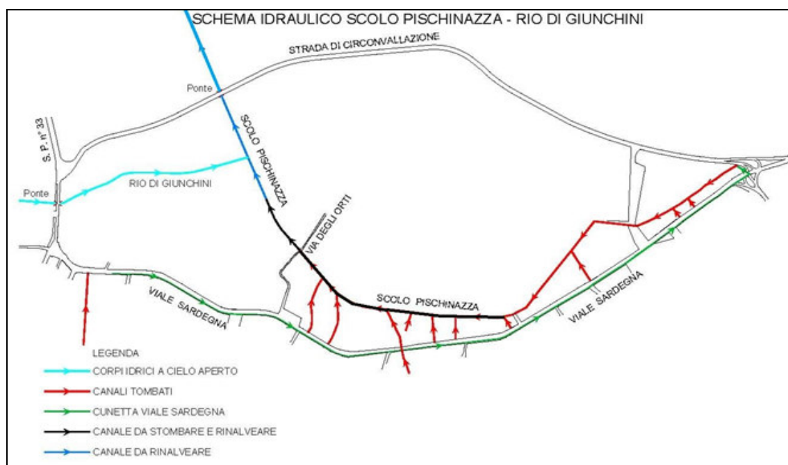
Figura 2: Schema idraulico Scolo Pischinazza - Rio di Giunchini.
