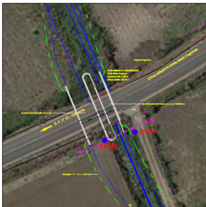
Figura 11: Planimetria delle indagini eseguite in corrispondenza dell'attraversamento con la SP33.
